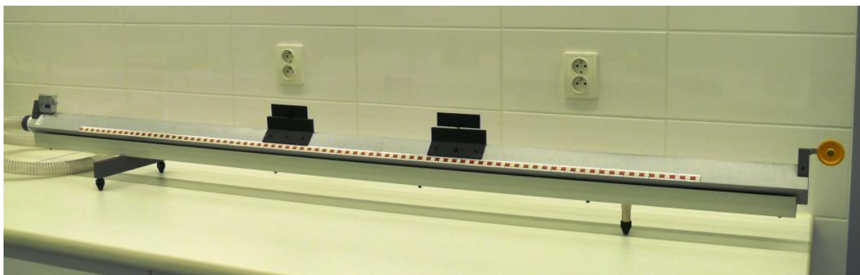
Obr. 3.2 Vzduchová dráha s vozičky
