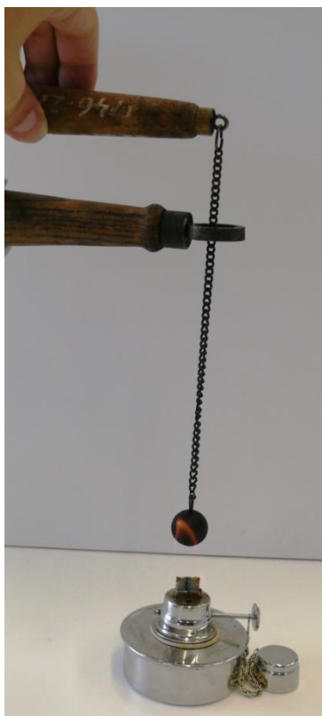
Obr. 20.2 Demonstrace teplotní objemové roztažnosti
