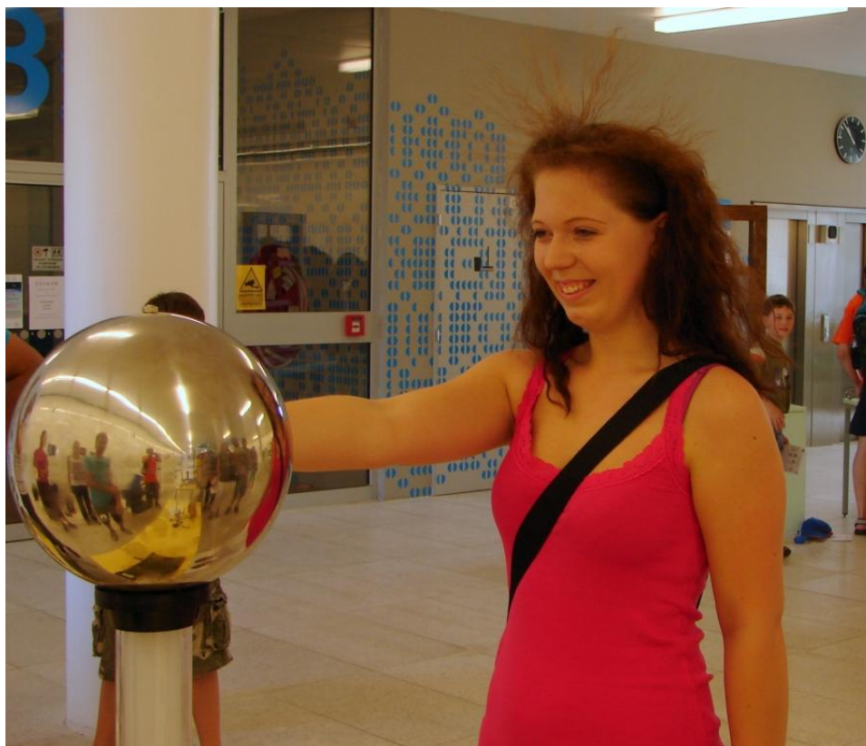
Obr. 27.3 Demonstrace, že vlasy nabity stejným nábojem se vzájemně odpuzují
