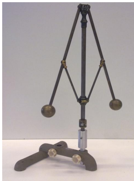
Obr. 9.3 Model Wattova odstředivého regulátoru
