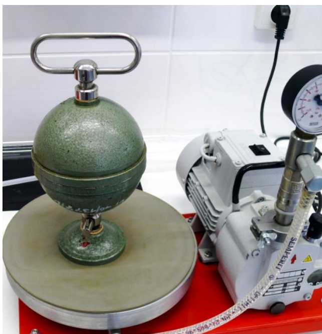
Obr. 14.1 Rotační olejová vývěva
