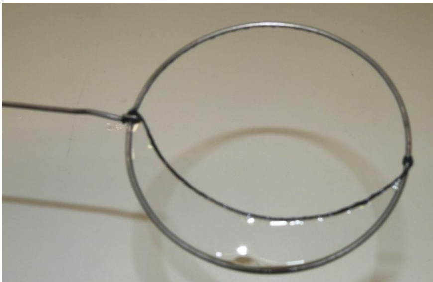
Obr. 19.3 Povrchová síla – Van der Mensbruggheův pokus
