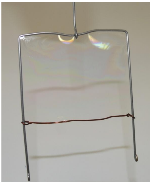
Obr. 19.2 Povrchová síla – Maxwellův pokus
