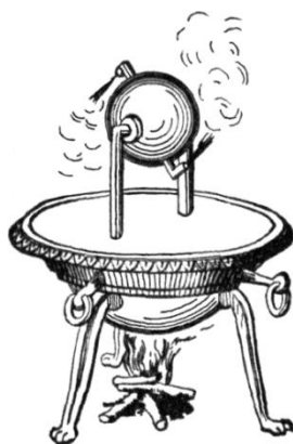
Obr. 7.2 Heronova parní baňka (převzato z http://upload.wikimedia.org/wikipedia/commons/3/3e/Aeolipile_illustration.JPG )
