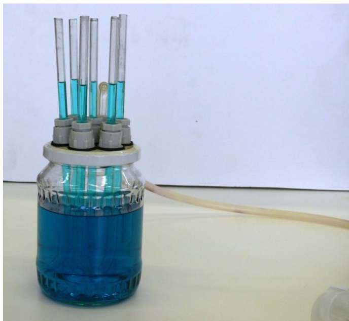
Obr. 10.1 Přístroj pro demonstraci Pascalova zákona
