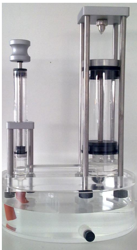
Obr. 10.2 Model hydraulického lisu
