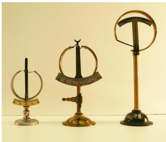
Obr. 14.8 Demonstrační Bourdonovy trubice
