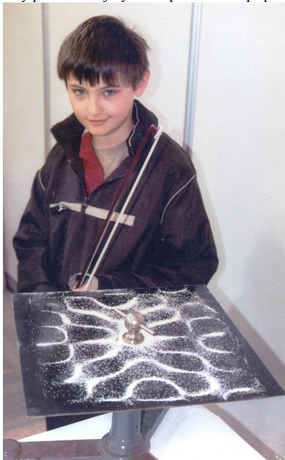
Obr. 25.1 Demonstrace chvění desek
